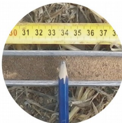
Detail, dobře patrný přechod humózní vrstvy vpůdotvorný substrát
